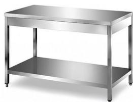
Struttura in acciaio inox, Top in acciaio inox AISI304, Top e ripiano inferiore piegati e saldati. Ripiano inferiore con traverso di rinforzo ad omega, Piedini regolabili, Montaggio facile con viti/bulloni inclusi
